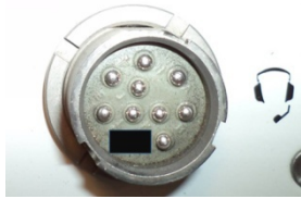
รูปที่ ๒ Connector Headset ที่เทปปิดที่ขา D
